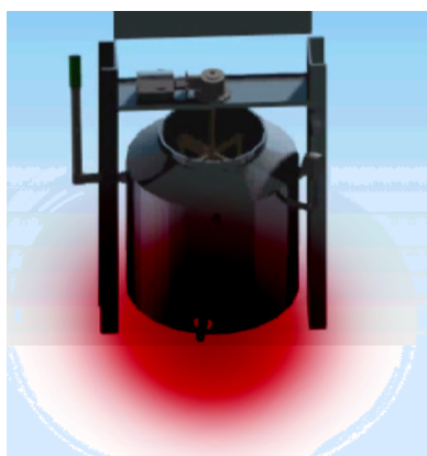
Figura 31. Calor radiado a) Original de la marmita y b) con la tapa metálica.
