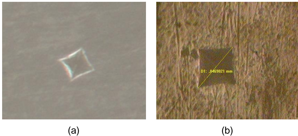
Figura 6.11. Imágenes de microscopía óptica de huellas hechas en superficies de las piezas pulidas conformadas con polvos sintetizados por (a) Pechini y (b) precipitación controlada.
