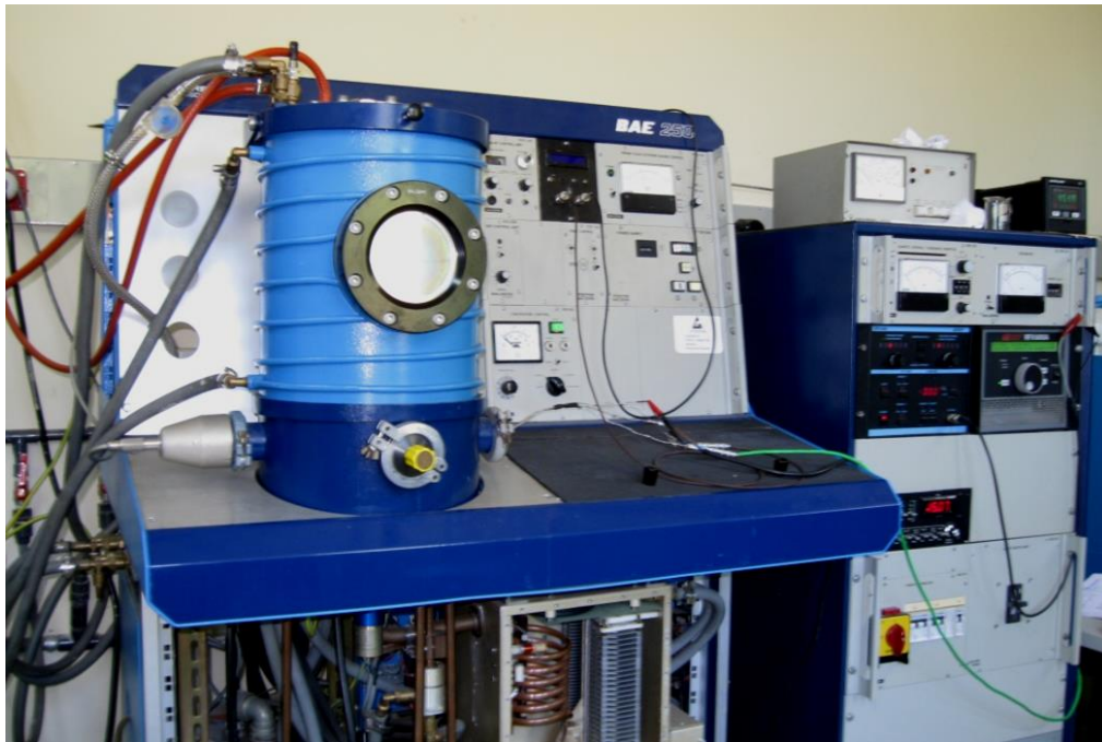
Figura 3.6: Equipo de pulverización Catódica; Magnetron Sputtering RF.
