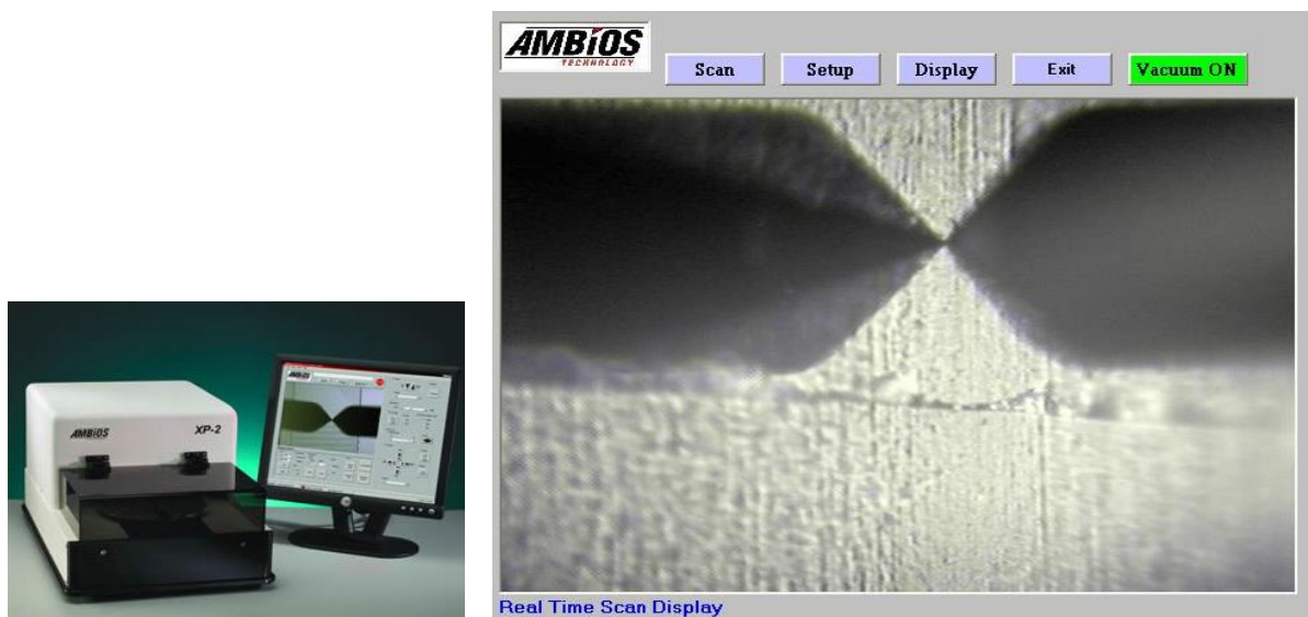
Figura 3.17: Perfilometro AMBIOS (izquierda) y vista de la sonda del perfilometro (derecha).
