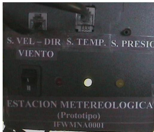
Figura. No. 42 Puertos de los sensores en el Data Logger
