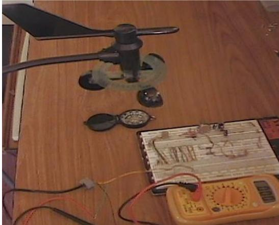
b) Esquema Calibración Para toma De datos Sensor De Dirección viento
