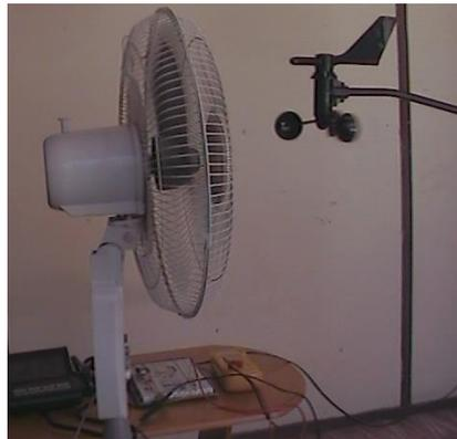
Figura. No. 33 Esquema experimental para la calibración del sensor de Velocidad del viento.
