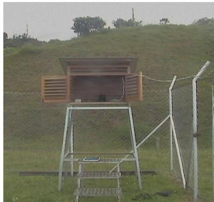
Figura. No 48 Garita de madera para data loger y sensores de temperatura y presión
