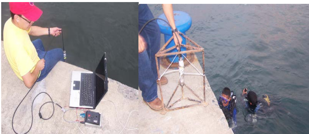
Figura 18. Configuración y prueba realizada con el sensor de presión
