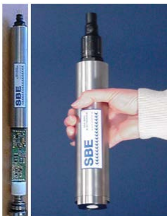
Figura 10. Sensor oceánico de presión SEABIRD SBE-50
