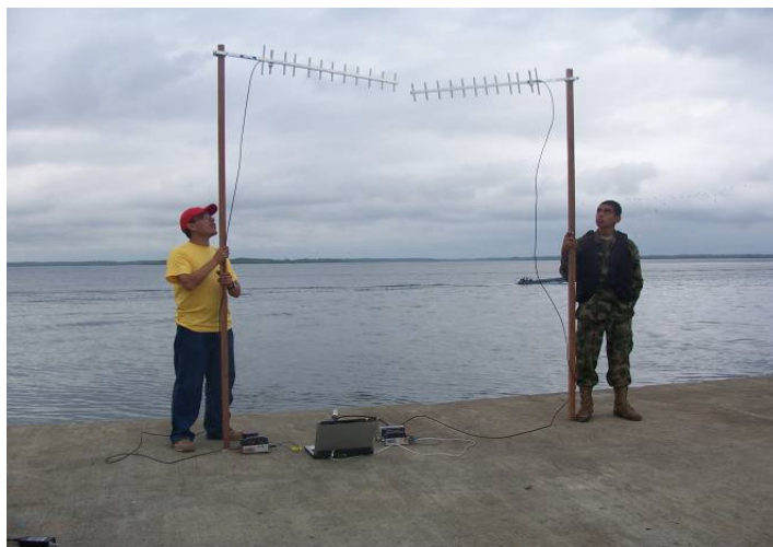
Figura 25. Prueba inicial de transmisión de datos utilizando antenas directivas
