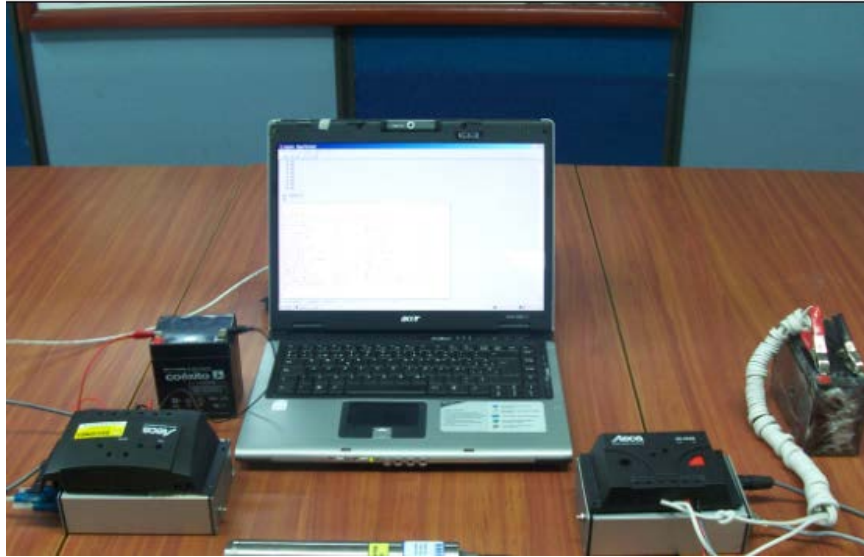
Figura 24. Prueba de configuración del radio modem maestro y esclavo
