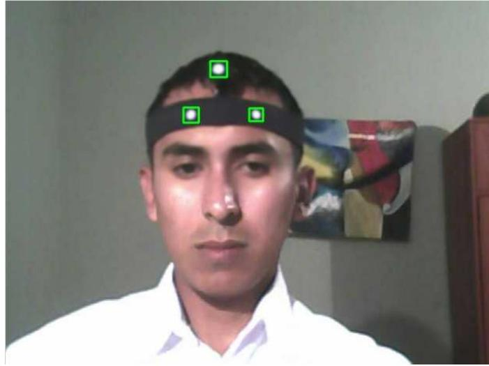
**Figura 28.** Detección del sistema de tres puntos por el método de integrales proyectivas.
