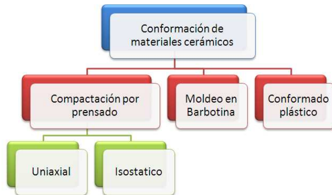
Figura 3.1 Técnicas de conformado utilizados para fabricar piezas cerámicas
