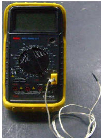
**Figura 15.** Imagen del sensor de temperatura utilizado.
