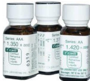
**Figura 27.** Líquidos certificados para calibración de refractómetros.
