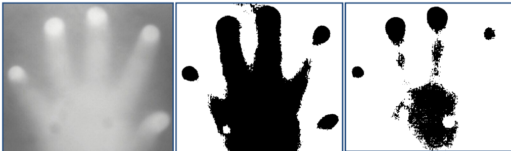
Figura 2.8. Ejemplo de umbralización de una imagen en escala de grises, utilizando un umbral de 180 y otro de 200.
