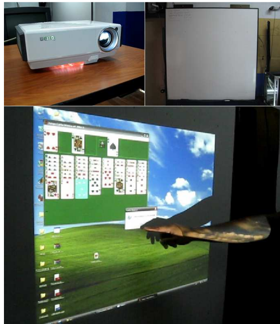
Figura 5.5. Componentes del sistema de proyección en el esquema con dos cámaras. En la parte de arriba se muestran los componentes empleados ( Video Beam y tablero) y abajo está el sistema en funcionamiento.
