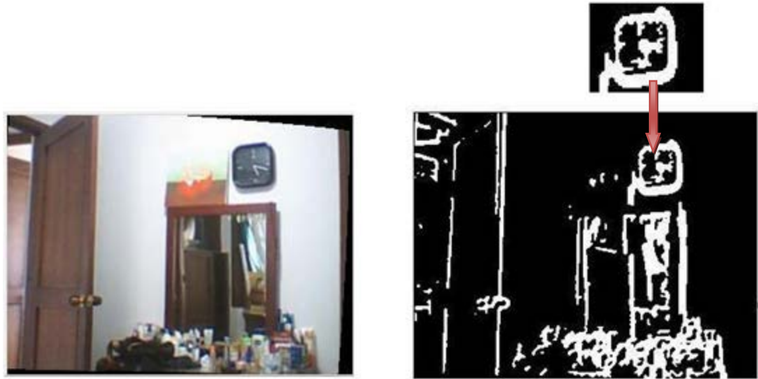
Fig. 3.14 Extracción de características con filtro Sobel. Fuente propia.
