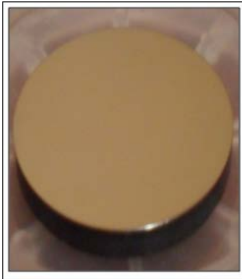
Figura 2.7. Acero AISI M2 sobre el cual se depositaron los recubrimientos compuestos de TiCN.
