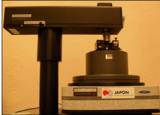
Figura 3.8. Equipo de microscopía de fuerza atómica Multitarea Auto Probe CP (Laboratorio de Física del Plasma de la Universidad Nacional de Colombia - Sede Manizales).
