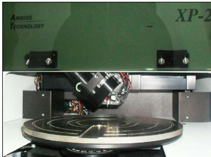
Figura 3.9. Equipo de profilometría Ambios Technology XP2 (Laboratorio de Recubrimientos Duros y Aplicaciones Industriales - Universidad del Valle).
