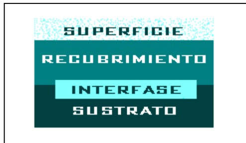
Figura 1.5. Representación esquemática de un sistema recubrimiento - sustrato.
