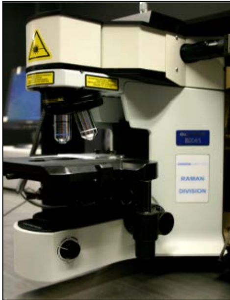
Figura 3.3. Equipo de espectroscopía Raman LabRam HR-800 (Laboratorio de Propiedades Ópticas de Materiales de la Universidad Nacional de Colombia - Sede Manizales).
