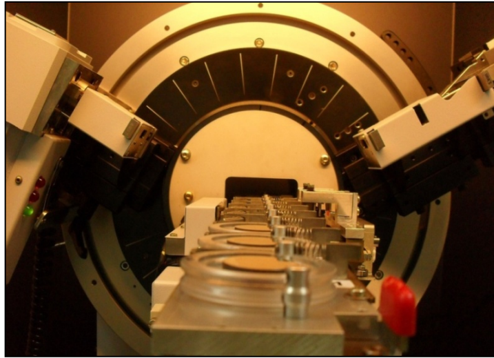
Figura 3.2. Equipo de difracción de rayos X Bruker D8 Advance (Laboratorio de Fabricación de Nuevos Materiales Semiconductores - Universidad del Quindío).
