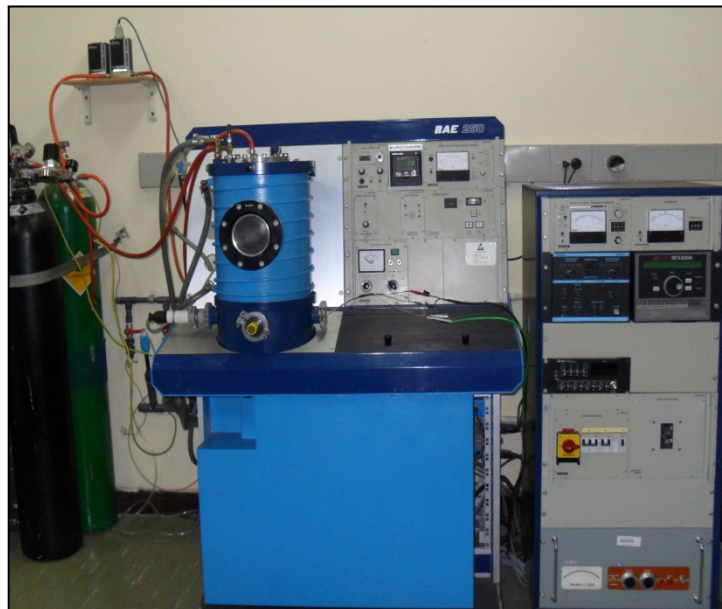
Figura 2.5. Equipo de pulverización catódica Balzers BAE 250 (Laboratorio de Física de Bajas Temperaturas - Universidad del Cauca).
