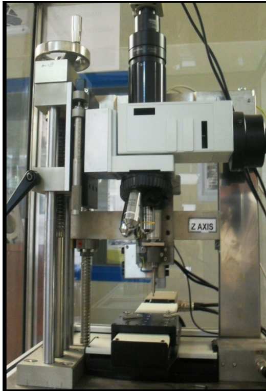
Figura 3.13. Equipo de nanoindentación dinámica Nanovea (Laboratorio de Recubrimientos Duros y Aplicaciones Industriales - Universidad del Valle).
