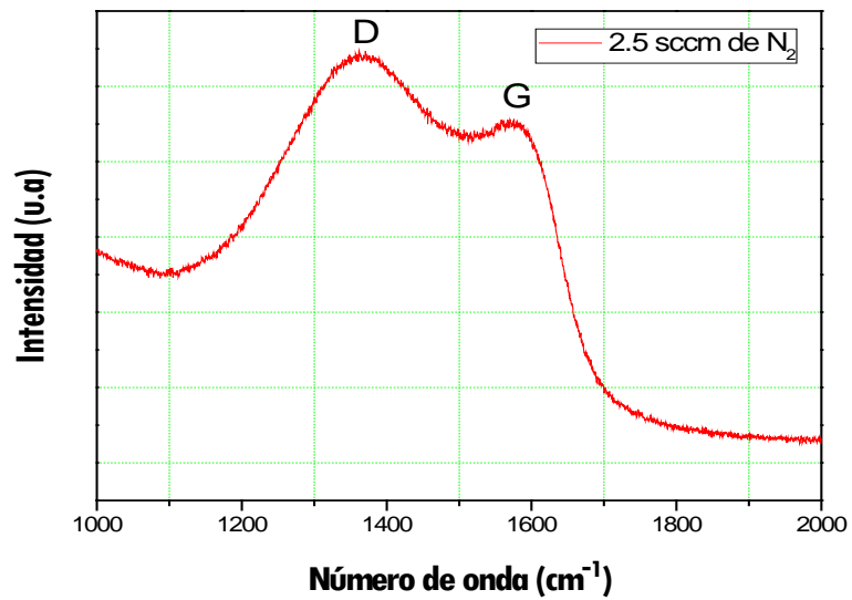
Figura 4.6. Espectro Raman de un recubrimiento de TiCN crecido con un flujo de 2.5 sccm de N 2 y una potencia de ignición para el plasma de 50 W.
