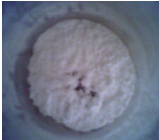
Figura 4.10. Material obtenido al secar a 80° C, la suspensión de titanio obtenida al final del proceso sol – gel.
