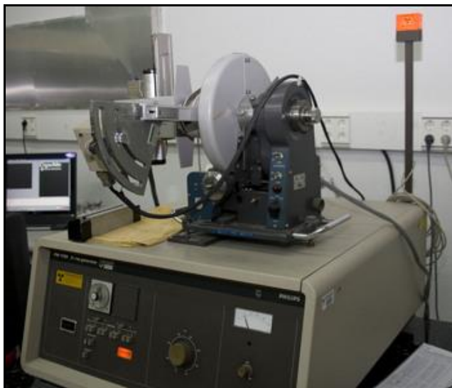
Figura 3.8. Difractómetro de rayos X (DRX), marca Philips PW1710, utilizado en este trabajo.
