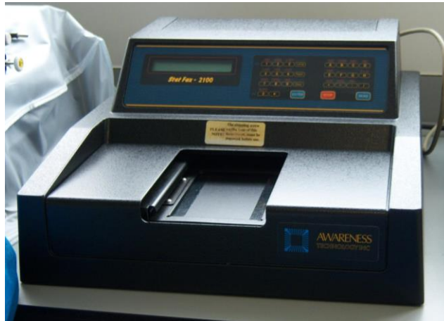
Figura 2.6. Espectrofotómetro multiplicas - Medidor de placas ELISA.
