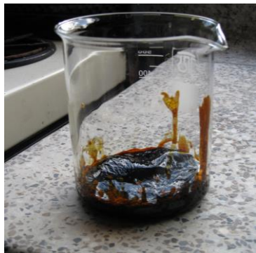
Figura 5.1. Fotografías que ilustran de la evolución y formación de la resina polimérica durante el desarrollo del proceso Pechini.
