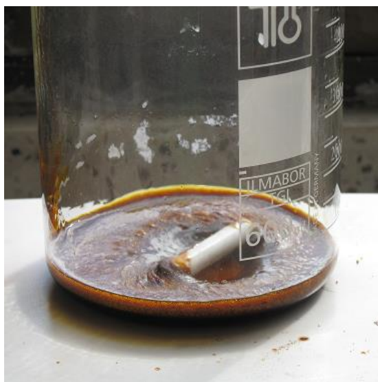
Figura 3.4. Etapa de conformación de la resina durante el desarrollo del proceso Pechini, utilizado para sintetizar el \text{TiO}_2 utilizado en este trabajo.
