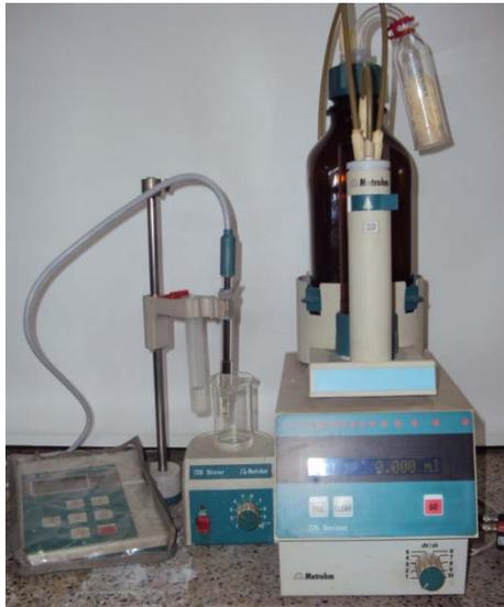
**Figura 2.10.** Sistema utilizado para obtener la curva de valoración potenciométrica y en general para realizar la síntesis de los polvos cerámicos de estaño-hierro.
