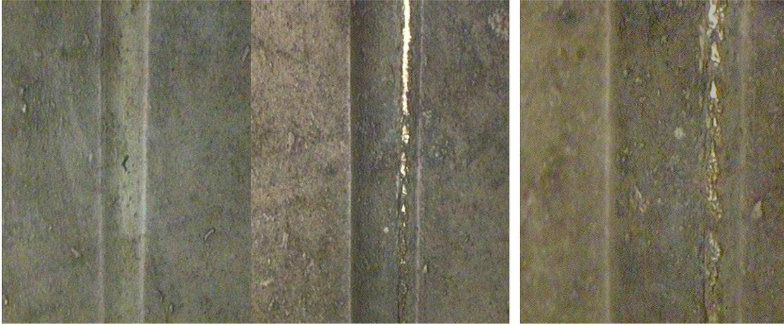
**Figura 51.** Huellas de desgaste de los recubrimientos VC
