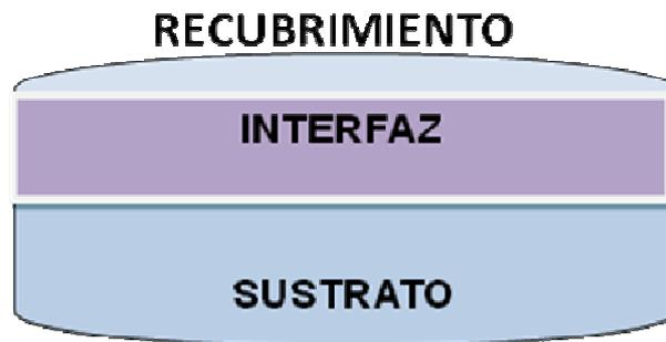
**Figura 1.** Sistema sustrato – Recubrimiento duro.
