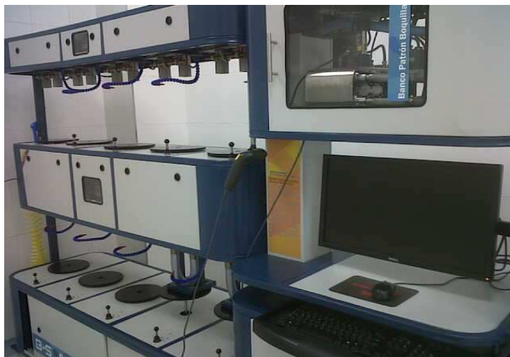
Figura 9. Vista general Banco de Boquillas Sónicas B-SONIC
