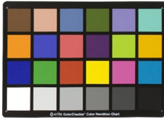
Figura 61. Carta de color ColorChecker Macbeth utilizada para ejecutar la caracterización de la cámara industrial.
