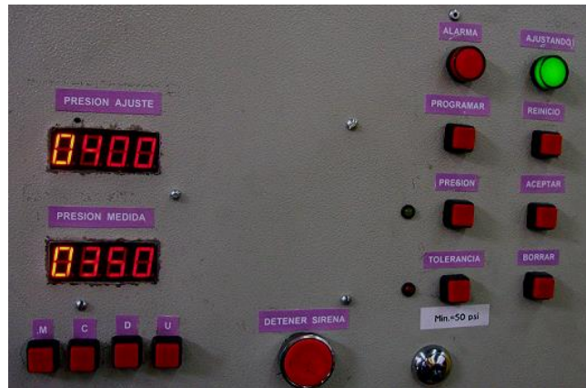
Figura 45. Momento en el cual el sistema de control de presión va a realizar la corrección.
