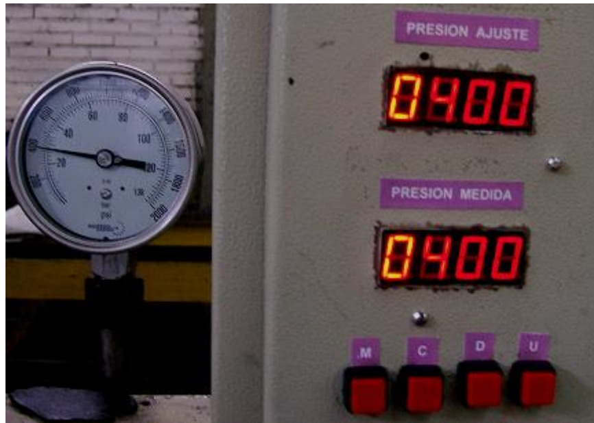
Figura 44. Prueba del sistema de control de presión implementado programado con una Presión Ajuste de 400 psi.
