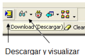
Fig. 24. Descargar el programa y visualizarlo en PLC
