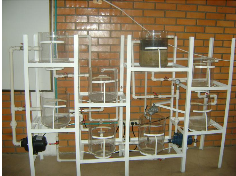
Fig. 1. Sistema tratamiento de aguas industriales
