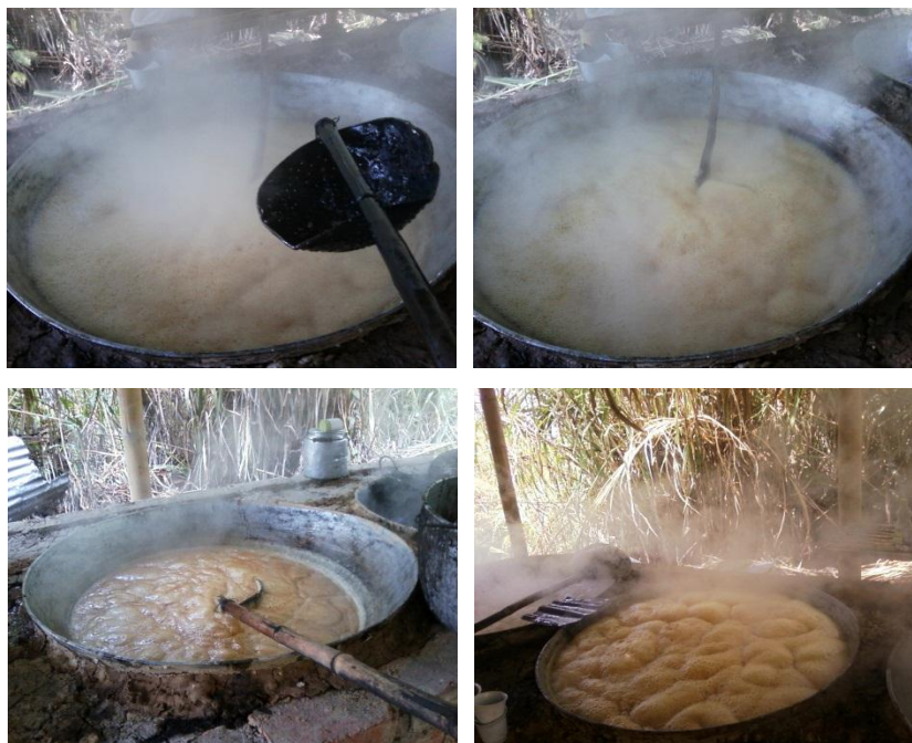
Figura 4.16. Etapas de evaporación y concentración del los jugos hasta el punto.
