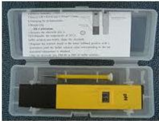
Figura 3.1. Fotografía del pH-metro manual
