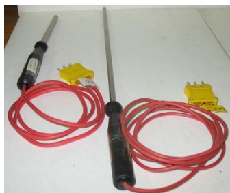
Figura 3.2.2. Termocupla tipo J
