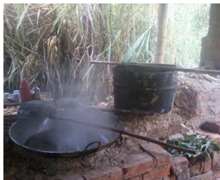
Figura 4.14. Concentración de los jugos, medición de la cantidad de sólidos solubles
