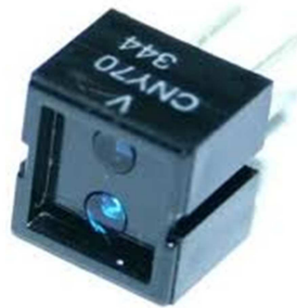
Figura 42. Sensor infrarrojo CNY70.
