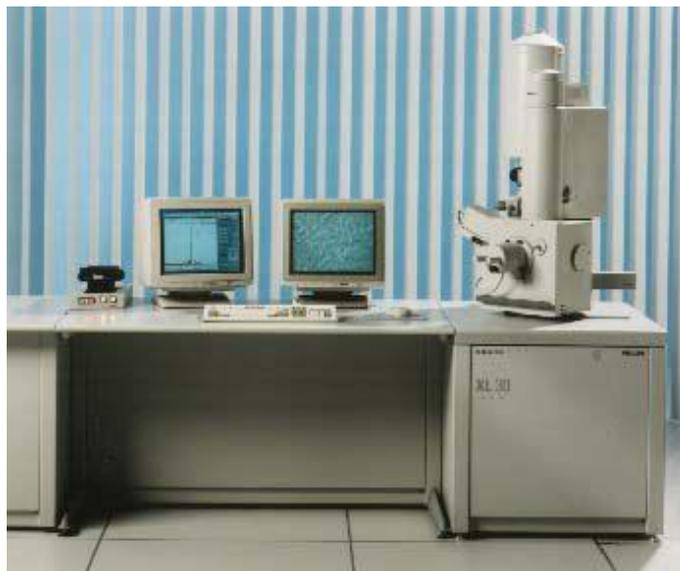
Figura 2.9. Microscopio electrónico de Barrido, marca Philips modelo XL30-FEG (Universidade Federal de Sao Carlos, Brasil), utilizado en este trabajo.
