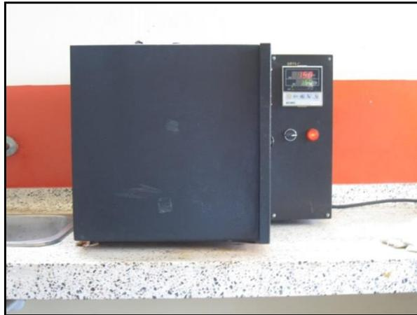
Figura 2.5 Horno Maxthermo utilizado para el tratamiento térmico de los polvos cerámicos.
