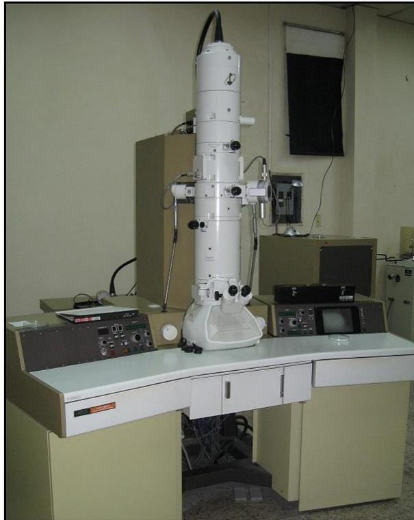
Figura 2.8. Microscopio electrónico de transmisión (MET), marca JEOL JEM-1200 (Unidad de Microscopia Electrónica – Unicauca), utilizado en este trabajo.
