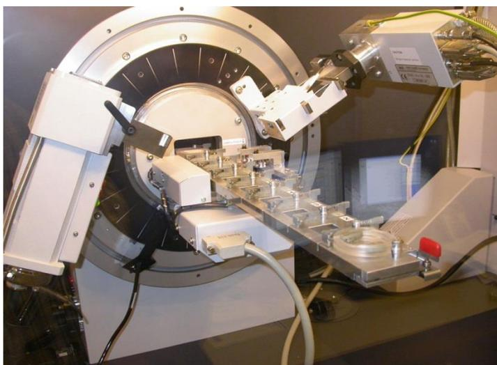
Figura 2.7 Difractómetro marca *BrukerD8 Advance*, utilizado en este trabajo
