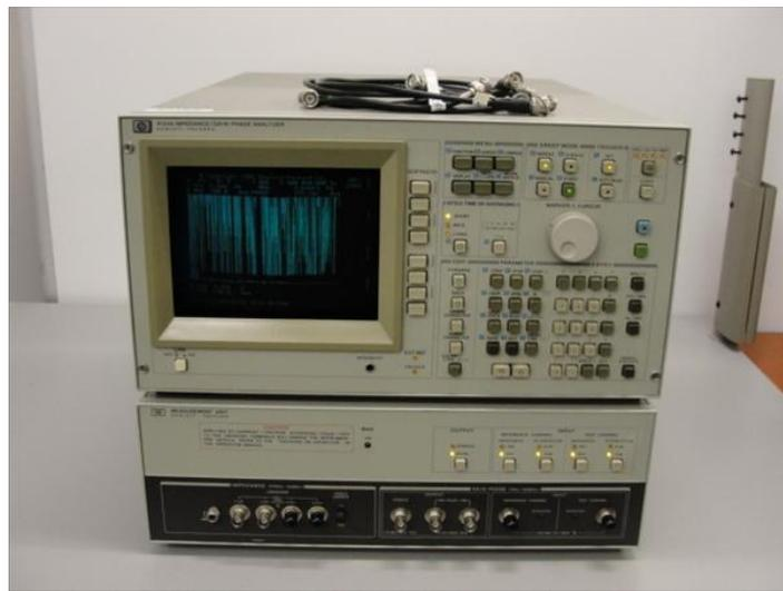
Figura 2.14 Analizador de impedancia Hewlett Packard modelo 4194A
