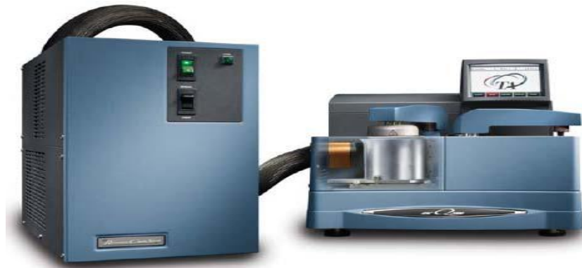
Figura 25. Sistema de refrigeración y control programado de la temperatura (RCS)
