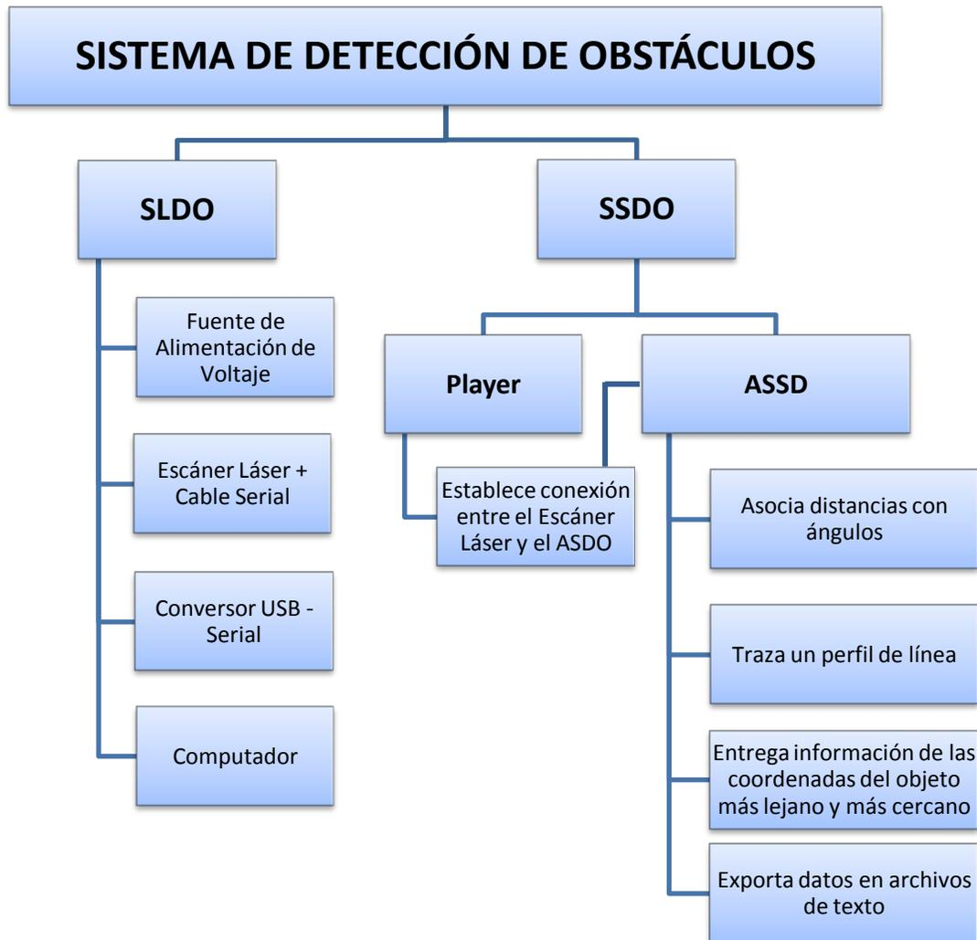
Figura 4.1. Diagrama del Sistema de Detección de Obstáculos.
