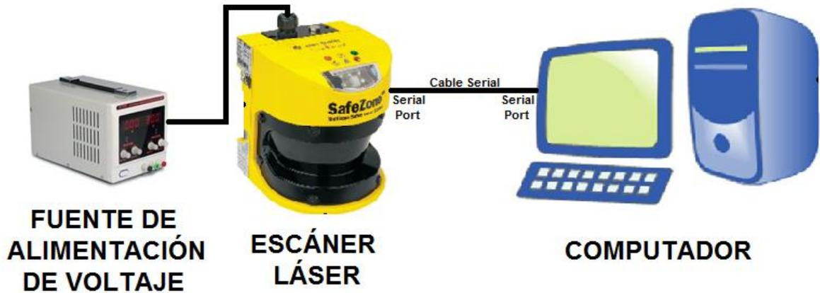
Figura 4.2. Hardware usado en el Sistema Láser para Detección de Obstáculos
