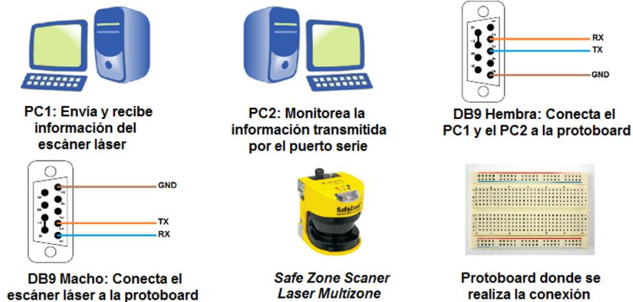
Figura 3.13. Elementos hardware usados en los experimentos y validaciones.
