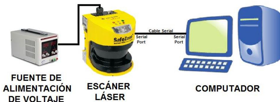
Figura 5.1 Montaje hardware usado para los experimentos de validación.
