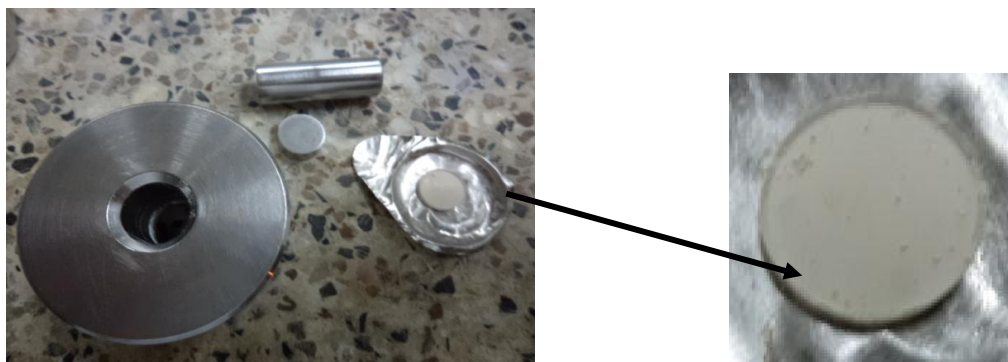
Figura 1.32. Pastilla de SBNF50 sometida a 3.5 Ton, durante 5 minutos.
