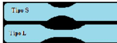
**Figura 2.17** Probetas de Tracción de impacto según norma ASTM D6110, [20].
