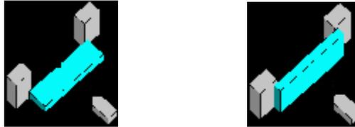
**Figura 2.10** (a) Impacto en el borde con probeta entallada, (b) Impacto plano con probeta sin entalla, [16].
