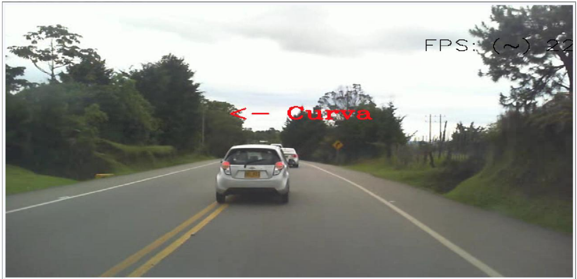
Figura 37. Indicación de curva a la izquierda luego de procesar la imagen. 37
