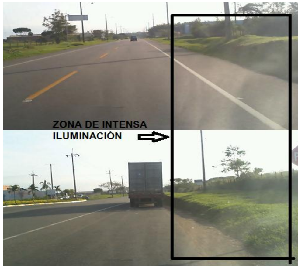
Figura 32. Luces parasitas capturadas por la webcam . 32
