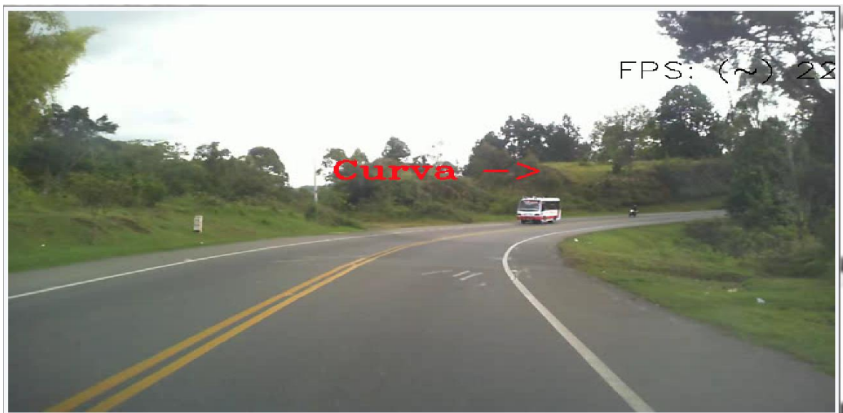
Figura 36. Indicación de curva a la derecha luego de procesar la imagen. 36
