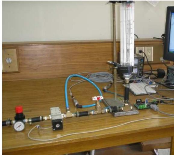
**Figura 17.** Montaje realizado para obtener Caudal vs Pasos de la válvula proporcional
