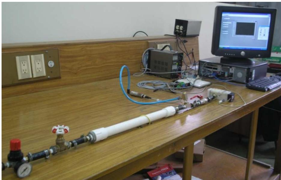
**Figura 22.** Montaje en el laboratorio para caracterización de componentes neumáticos por el método JIS B8390 (Método de descarga de tanque)
