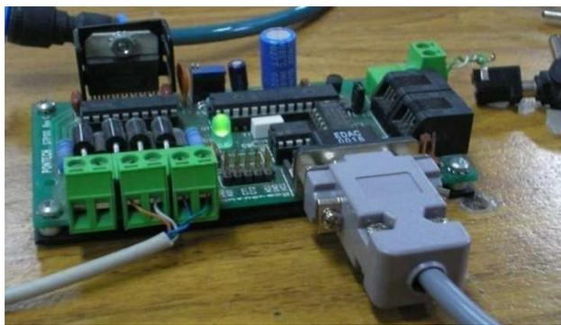
**Figura 16.** Controlador STP100 del motor paso a paso de la válvula proporcional
