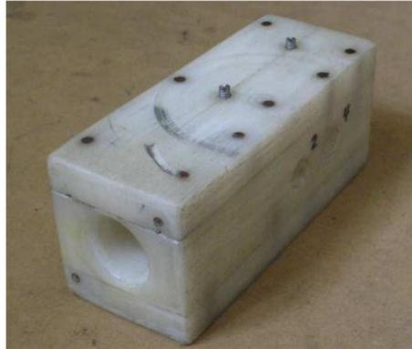
**Figura 14.** Construcción Parcial del cuerpo de la válvula. En el eje principal asoma la camisa por donde se desplaza el carrete de la válvula
