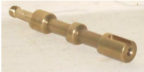
**Figura 13.** Carrete mecanizado en torno de la válvula proporcional
