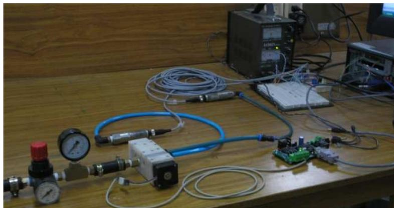
**Figura 19.** Montaje realizado para caracterizar la valvula: Presión vs Pasos de motor
