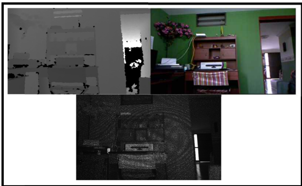
Figura 3.1. Información entrega por el Kinect. Imagen de Color (Derecha), Imagen de profundidad (Izquierda), Imagen infrarroja (Abajo).
