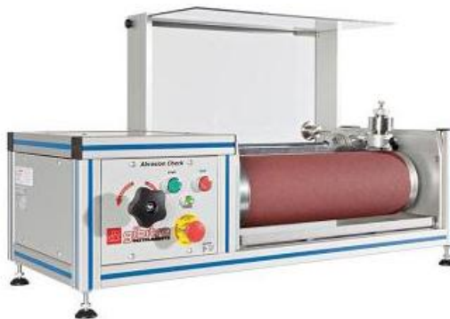
Figura 3.4. Abrasímetro utilizado para realizar las pruebas de abrasión de las bandas de caucho.
