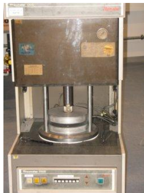
Figura 3.2 Reómetro usado para realizar los ensayos de reología de las muestras
