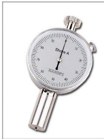
Figura 3.5. Durómetro “Shore A” usado para medir la dureza de las bandas de caucho de interés.
