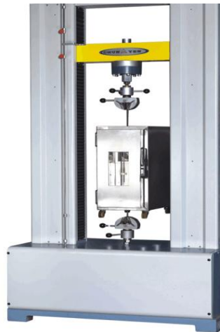
Figura 3.6. Equipo utilizado para la realización de las pruebas de adhesión de Caucho-Caucho (CC) y Caucho-Lona (CL)
