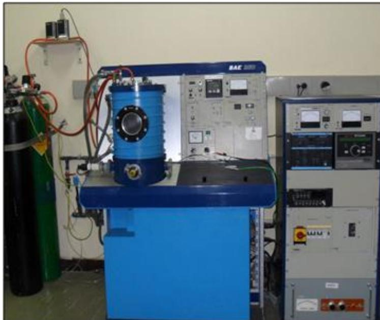
Figura 2.2. Magnetron sputtering Balzers BAE 250 del laboratorio de física de bajas temperaturas de la Universidad del Cauca.
