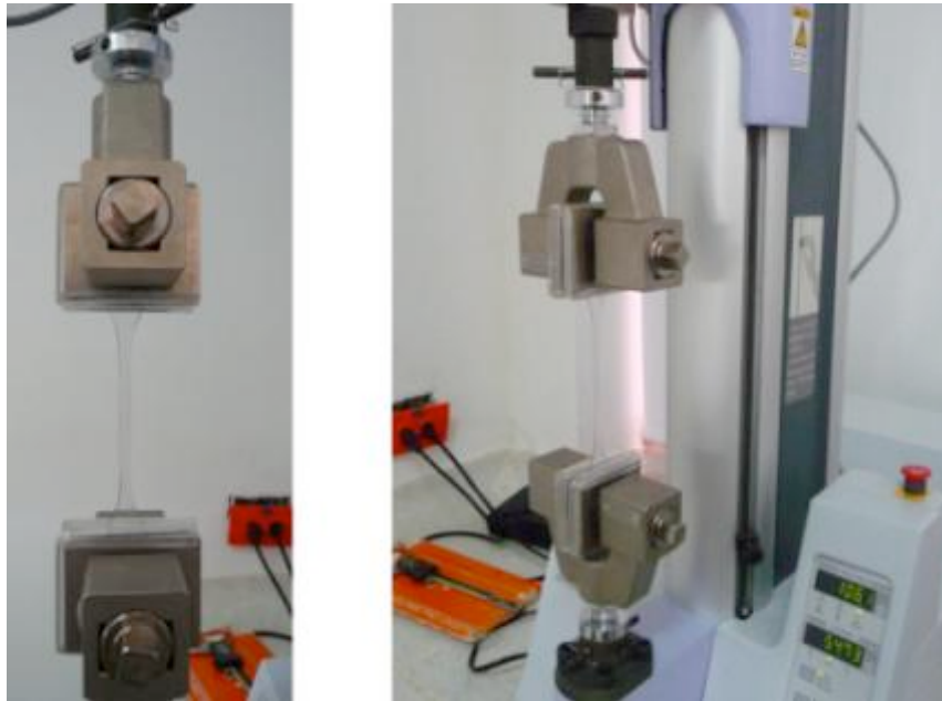
Figura 1.4. Funcionamiento de la máquina de ensayo de tensión. Fotografía tomada en el laboratorio CYTIBIA de la universidad del cauca.
