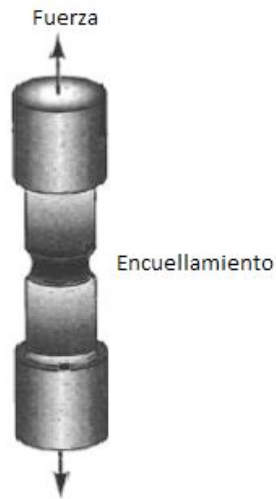
Figura 1.5. Encuellamiento ó estricción de la probeta.
