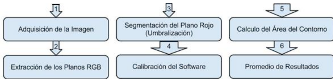
Figura 1.19. Diagrama de bloques para Software implementado en C++ con OpenCV.
