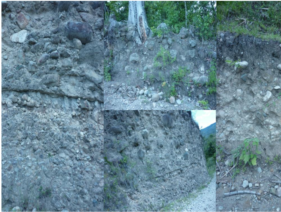
Figura 3.34 – Fotografía de cortes del suelo con conglomerados. Fragmentos de bolos, bloques y cantos.
