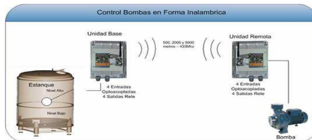
Figura 4.50 – Sistema de control inalámbrico.
