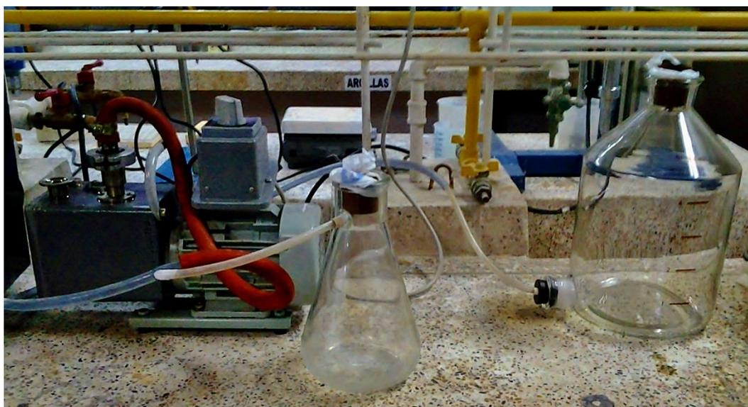
*Figura 4.4. Montaje para filtración al vacío.*
