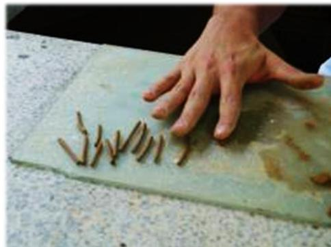
**Figura 1.8.** Moldeado de filamentos de arcilla para determinar el límite plástico.
