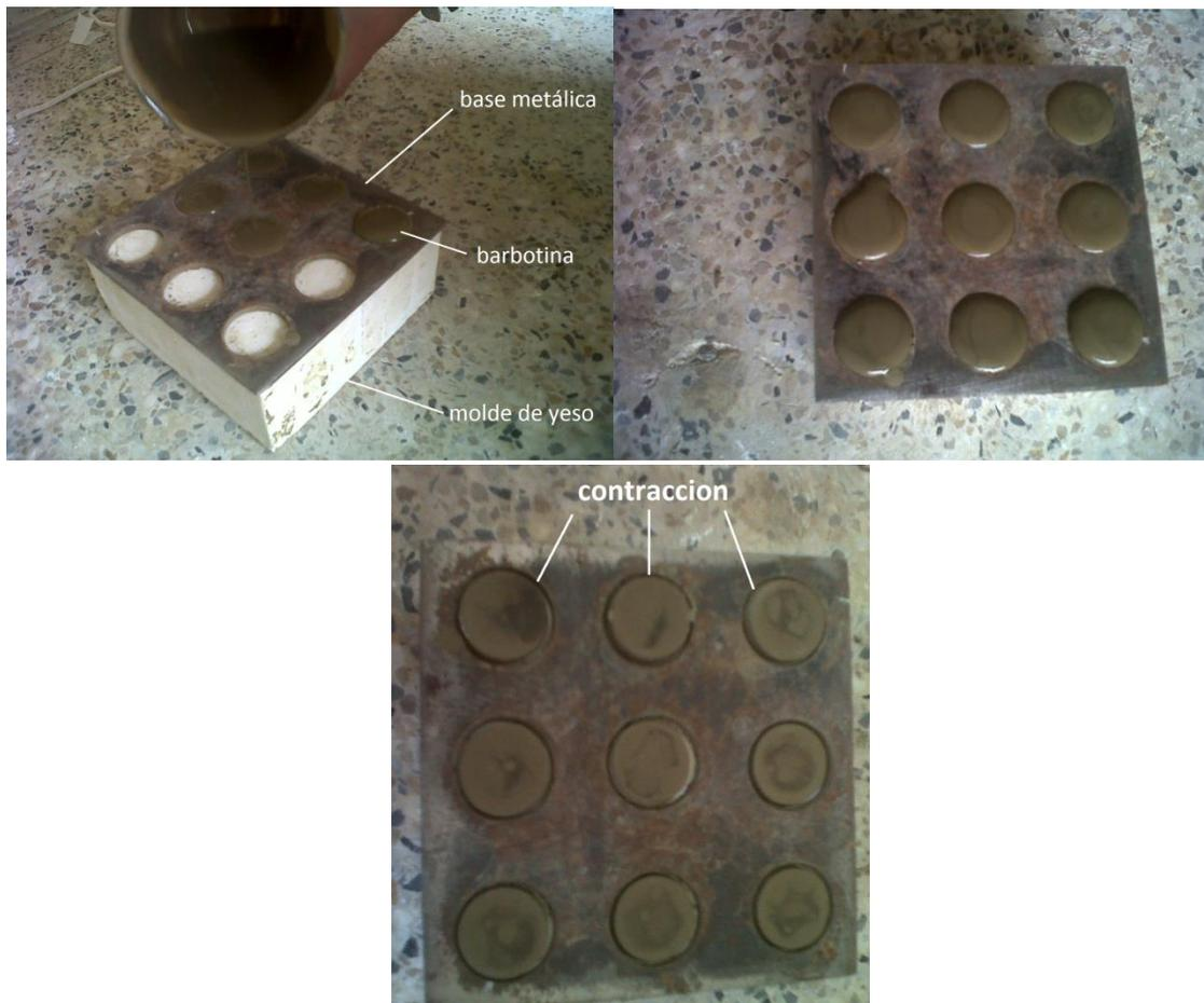
**Figura 3.10** Sistema yeso-base metálica, utilizado para conformar pequeñas pastillas
