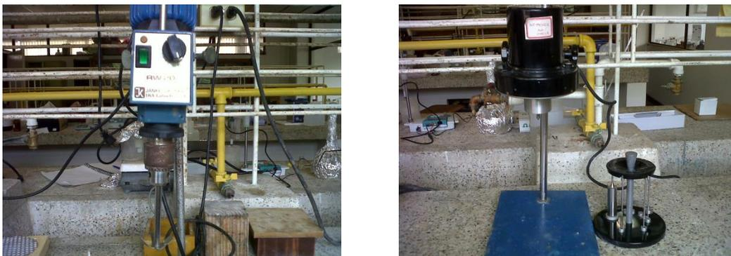
*Figura 2.4. Agitador eléctrico y viscosímetro utilizados para determinar la viscosidad de las suspensiones estudiadas*
