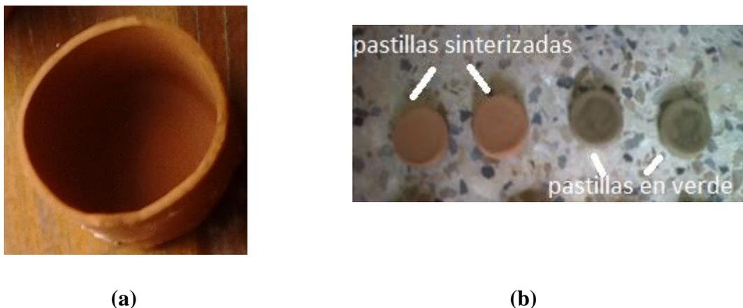
**Figura 3.16.** (a) Pieza cerámica obtenida por colado, sinterizada a 550°C durante 5 horas, y (b) pastillas en verde y sinterizadas a 550°C (5 horas)
