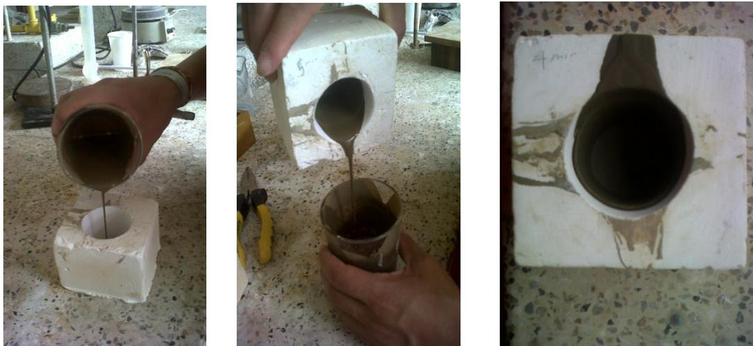
*Figura 3.7. Pasos del colado desde el vaciado en el molde hasta el conformado de la pieza dentro de él.*
