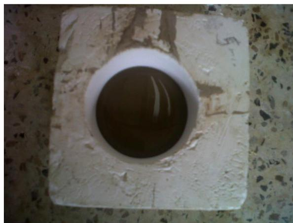
*Figura 3.6. Vaciado de la barbotina en el molde de yeso*
