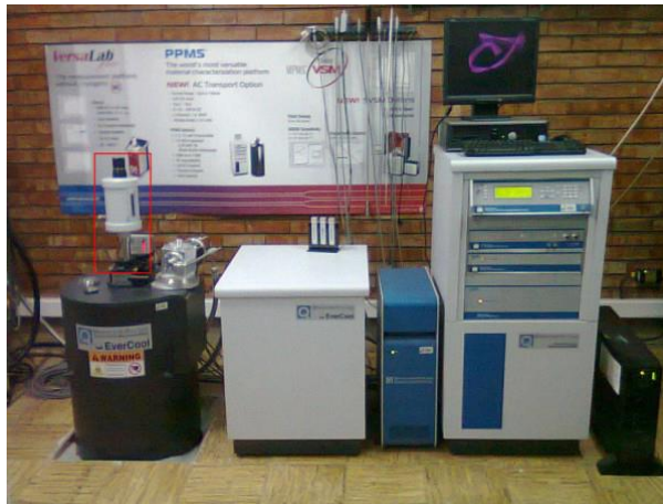
Figura 2.16 Sistema de Medición de Propiedades Físicas con el módulo de Magnetómetro de Muestra Vibrante (recuadro rojo izquierda).
