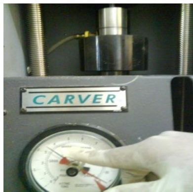
Figura 2.13 Prensa uniaxial utilizada en la compactación de los polvos cerámicos de SBN-Co.
