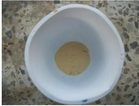
Figura 2.4 Aspecto final de los polvos cerámicos obtenidos por el método gel citrato, después del tratamiento térmico a 900°C/4h.
