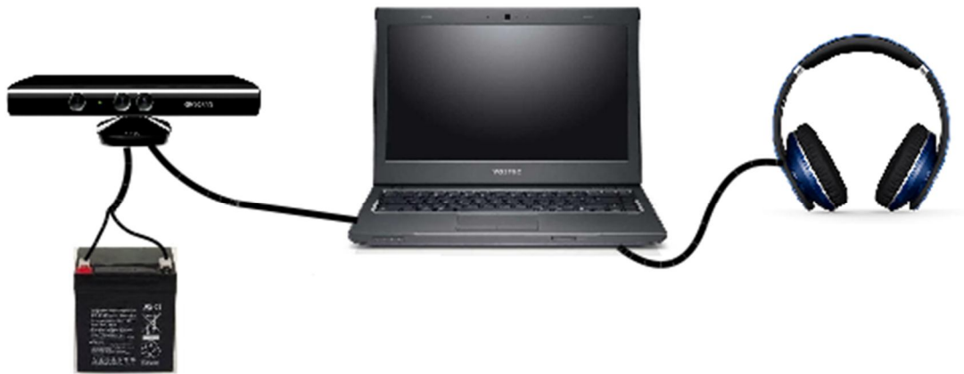
Figura 34. Prototipo de laboratorio, reproduce un EAV a partir de imágenes de mapas de profundidad
