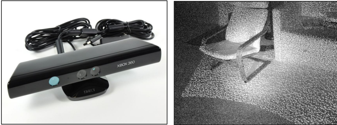
Figura 16. Dispositivo Óptico (Kinect) (iqz) 9 , Patrón de puntos proyectados por el Kinect (der) 10
