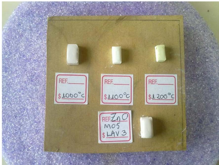
**Figura 3.22** Piezas cerámicas sinterizadas de muestras coladas del ZnO sintetizado por el método 2, sometido a 3 lavados.
