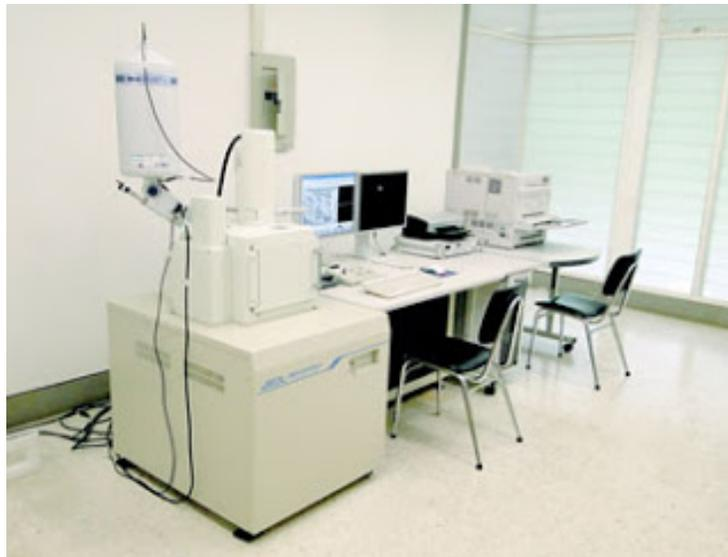
**Figura 3.25** Fotografía del equipo JEOL JSM-6490LV MEB utilizado para la caracterización microestructural de las piezas conformadas en este trabajo.
