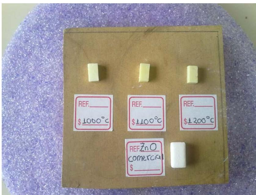
**Figura 3.20** Piezas cerámicas sinterizadas utilizando muestras coladas de ZnO comercial.
