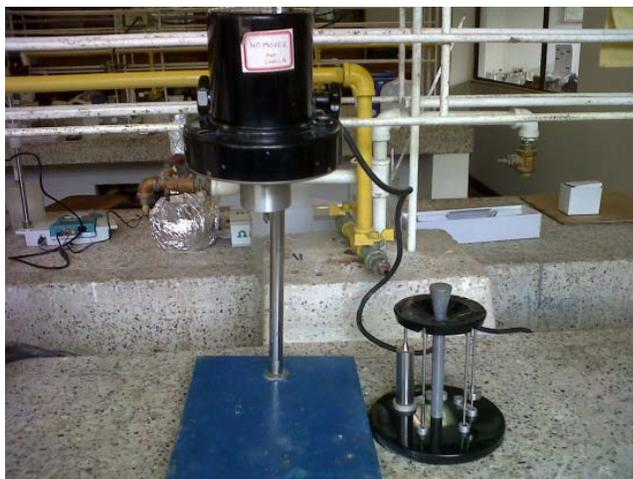
**Figura 3.2** Viscosímetro Brookfield- LVIII con sus respectivas agujas
