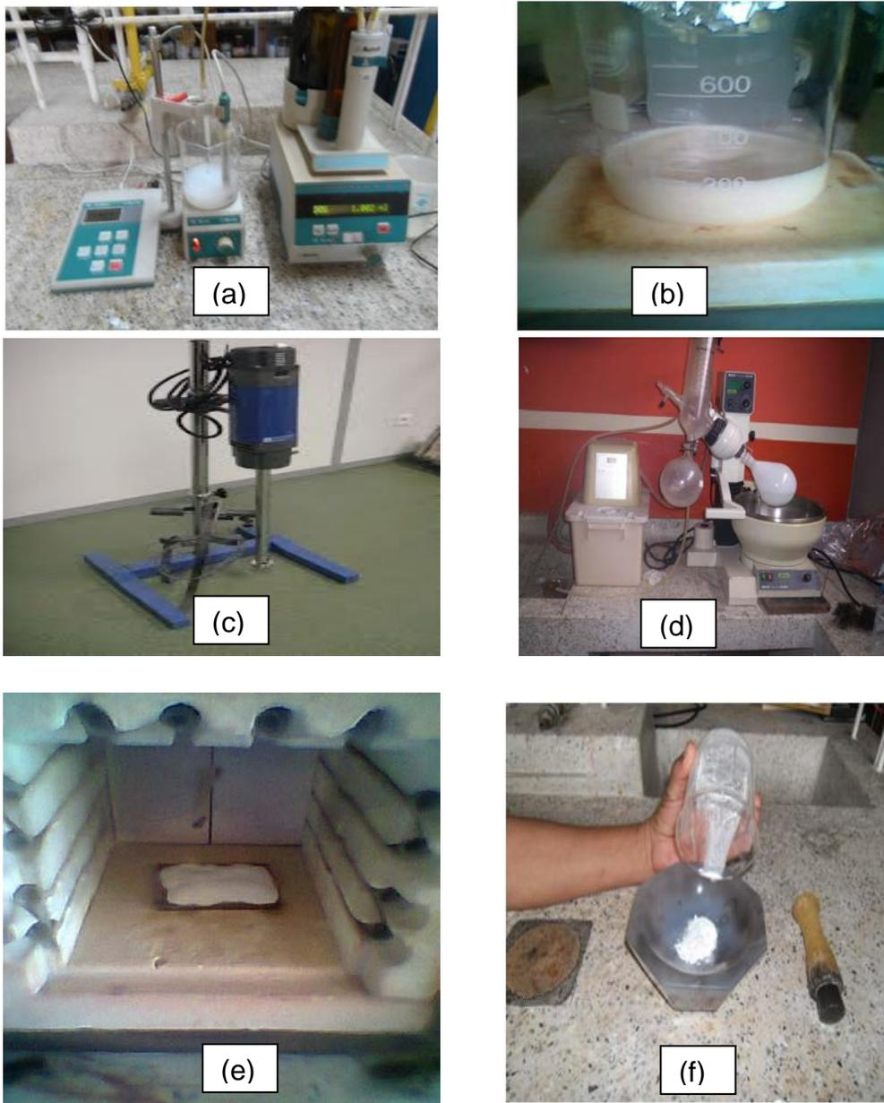
**Figura 2.2** Fotografías de las diferentes etapas del método de precipitación controlada utilizado para sintetizar el ZnO: (a) adición del hidróxido de amonio; (b) muestra envejecida 1 día; (c) redispersión de la suspensión envejecida; (d) Eliminación de la fase líquida; (e) Tratamiento térmico y (f) polvo cerámico obtenido después del tratamiento térmico.
