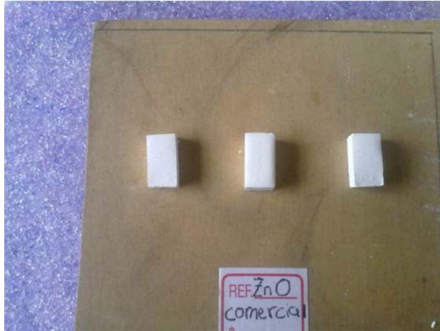
**Figura 3.16** Piezas cerámicas del ZnO comercial conformadas usando una barbotina con un valor de viscosidad correspondiente al punto mínimo de la figura 3.3.
