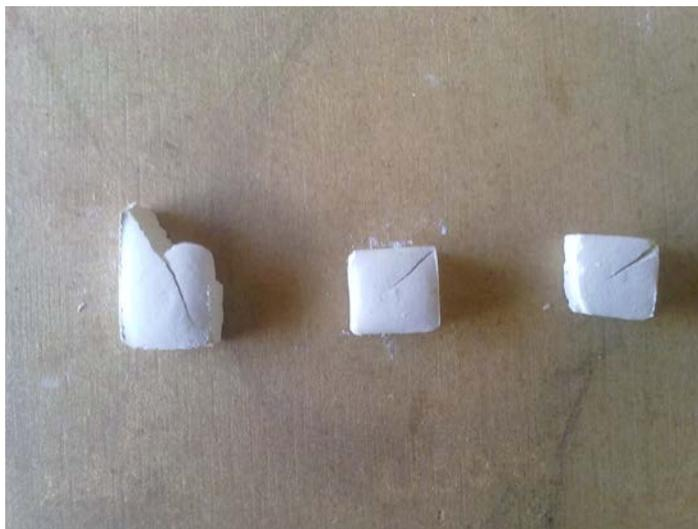
**Figura 3.15** Efectos de la viscosidad sobre la formación de las piezas de ZnO comercial.
