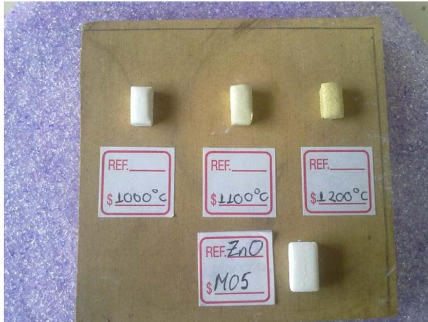
**Figura 3.21** Piezas cerámicas sinterizadas utilizando muestras coladas del ZnO sintetizado por el método 2, sin lavado.
