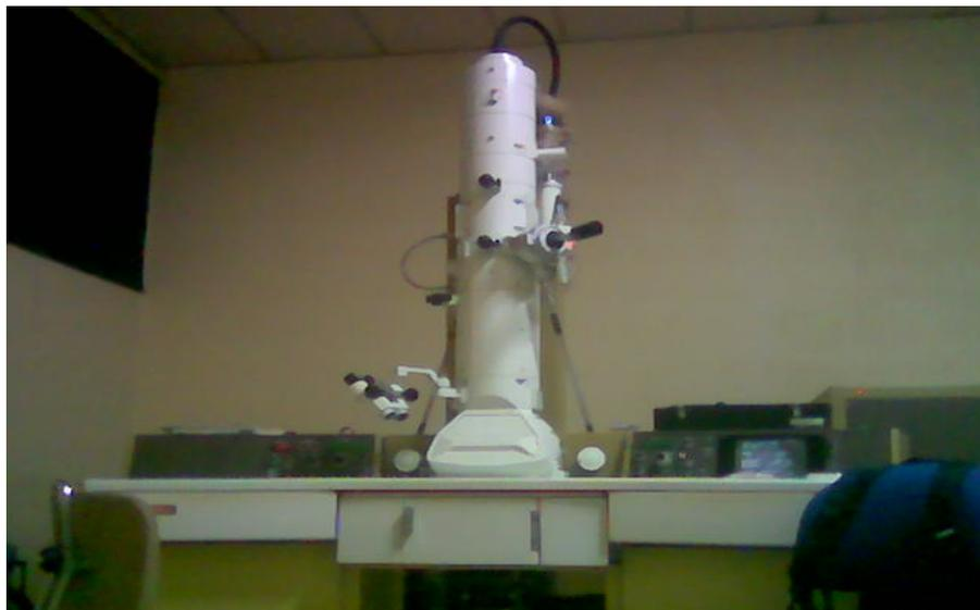
**Figura 2.8.** Microscopio Electrónico de Transmisión, ubicado en la Unidad de Microscopía de la Universidad del Cauca, utilizado para analizar muestras solidas sintetizadas en este trabajo.
