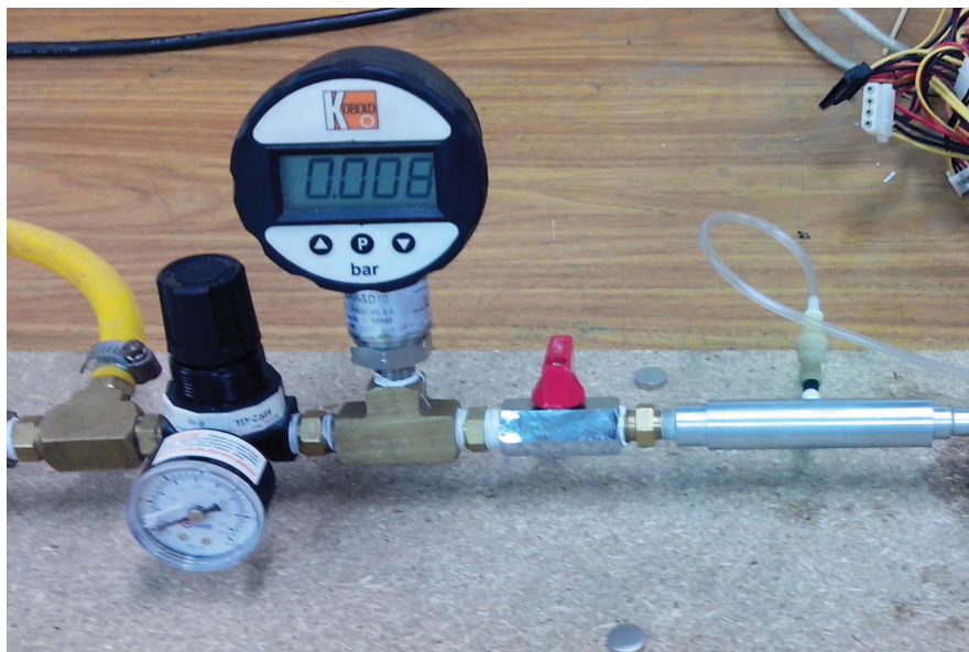
Figura 3.9: Sistema Tobera Obturador Real
