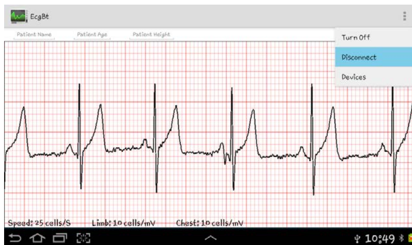
Figura 55 Despliegue gráfico en la aplicación para Android, de un potencial de acción cardiaco obtenido mediante el prototipo de electrocardiógrafo.
