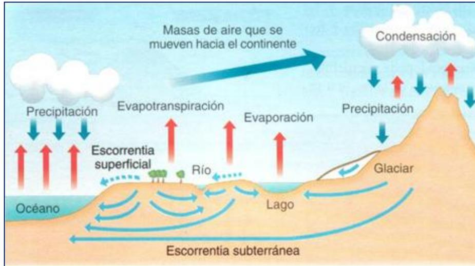
**Figura 1.1.** Ciclo hidrológico mostrando las fases: Precipitación (P), Evapotranspiración (ET), Escorrentía Superficial (ESD), Infiltración (I).
