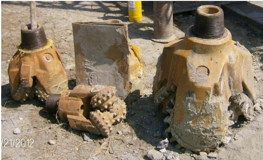
**Figura 6.5.** Brocas tricónicas de 17, 22 y 36 pulgadas.
