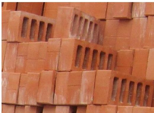
Figura 1.8. Producto finalizado, ladrillo # 12, extruido limpio para edificación a la vista.
