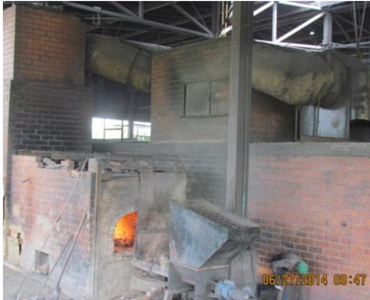
Figura 3.4. Hornilla generadora de aire caliente.
