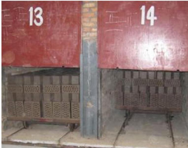
Figura 3.2. Entrada y salida de piezas moldeadas.
