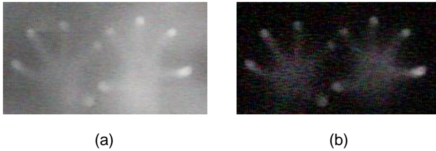
Figura 5.16. Imagen pre-procesada, a) Imagen detectada, b) Resta de background .
