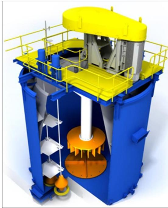
*Figura 21. Celda de Flotación Mecánica.*
