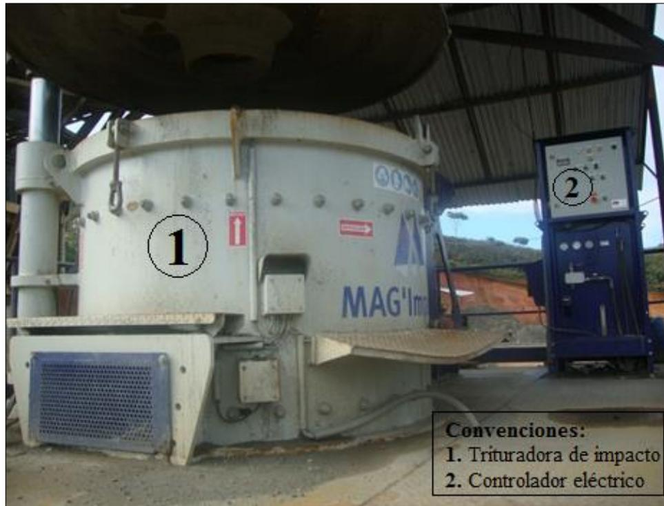
*Figura 12.* Impactor (Trituradora giratoria).
