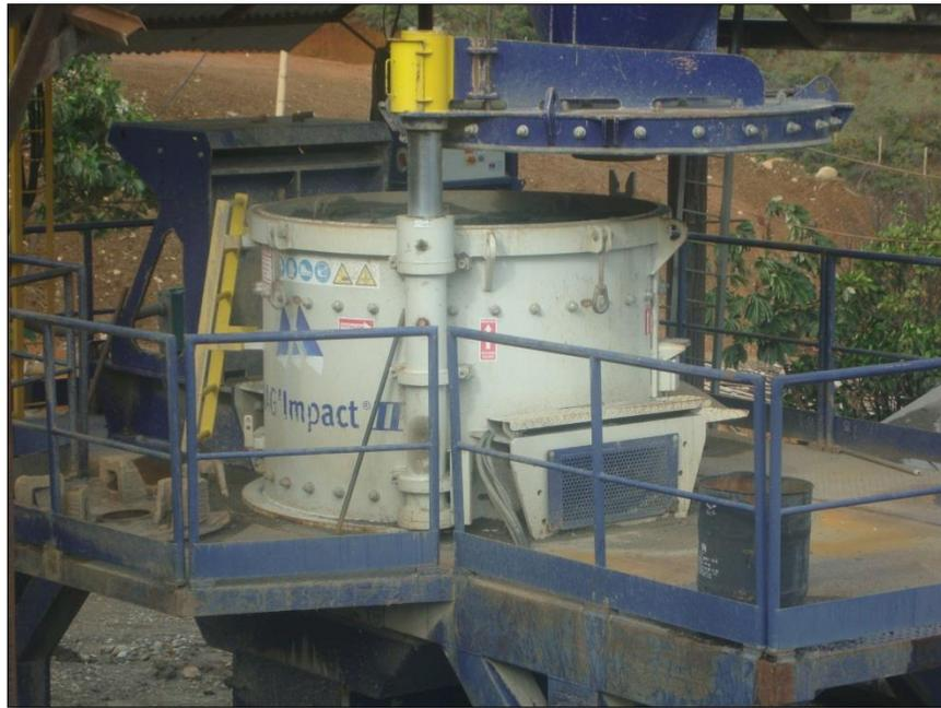
*Figura 34.* Trituradora de alta velocidad (Impactor)
