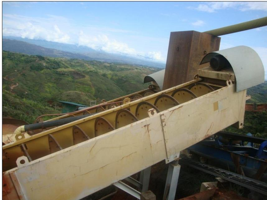
**Figura 32.** Estructuras Helicoidales de separación solido-liquido.
