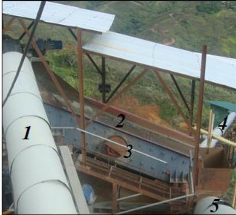
*Figura 35.* Tamiz industrial: 1. Banda de alimentación, 2. Medio de harneado (malla), 3. Contrapeso y desnivel mecánico, 4. Banda que transporta el producto del proceso, 4. Banda de transporte del sobretamaño.
