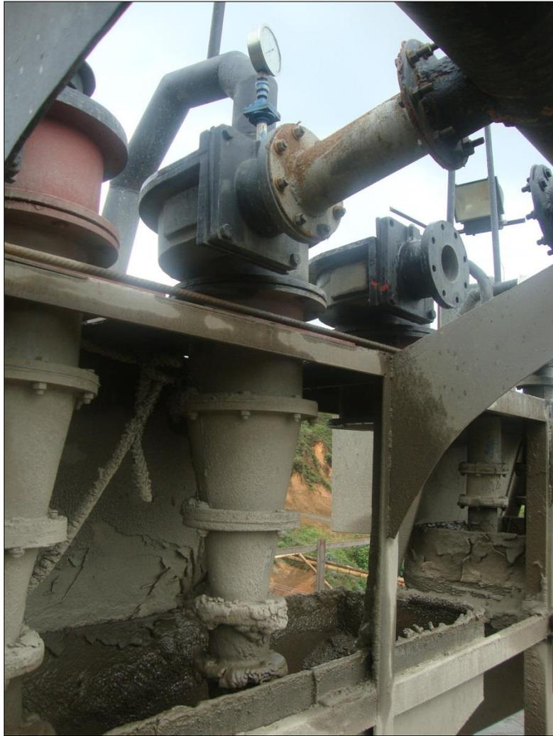
*Figura 39.* Dispositivo clasificador H10.
