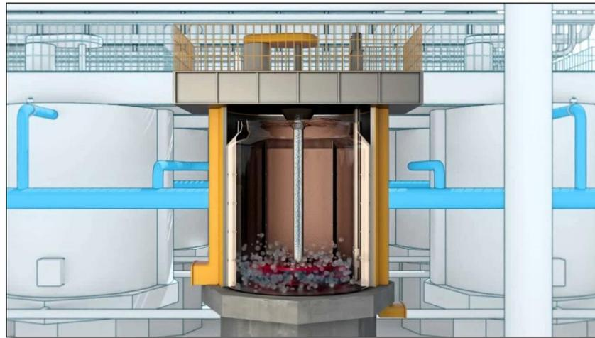
**Figura 20.** Banco de Flotación. El banco está conformado por varias celdas que forman un circuito en serie realimentado. Las celdas cuentan con un sistema de agitación y un sistema de aireación para formar y diseminar burbujas de aire en la parte inferior de la celda, como se ilustra en la figura.
