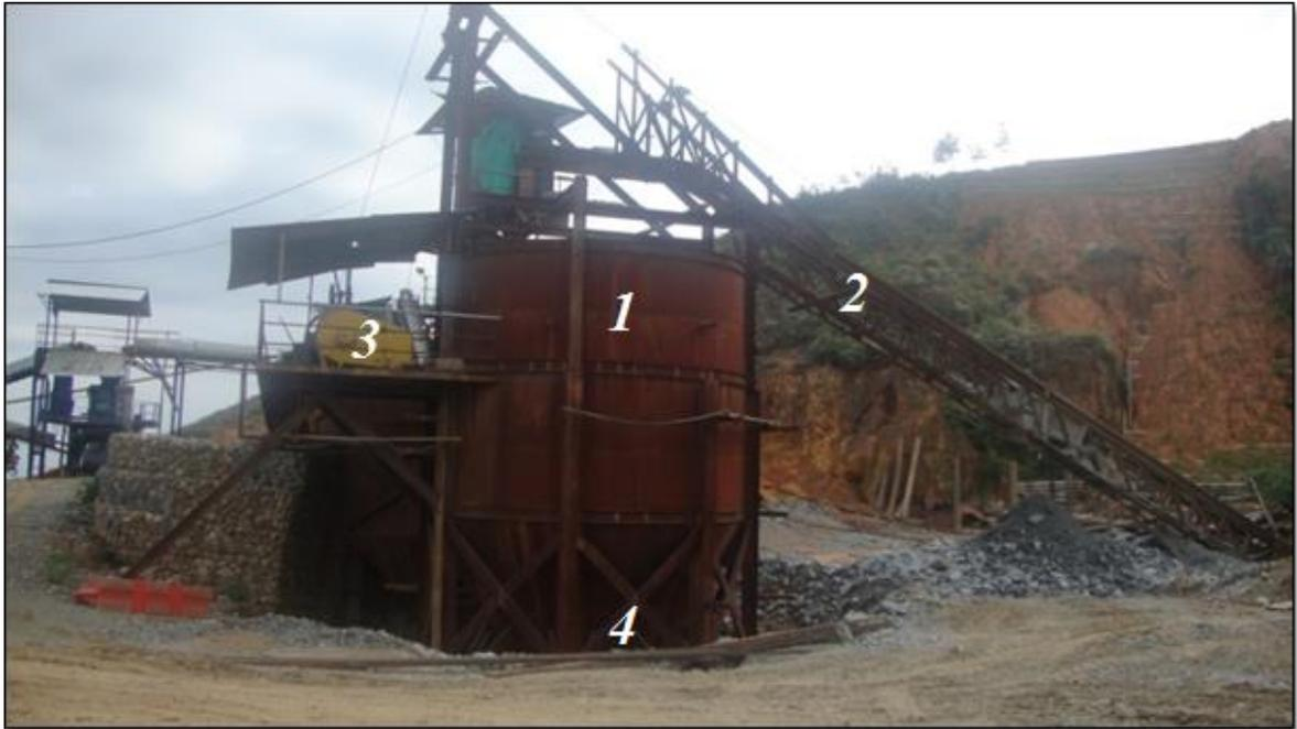
**Figura 30.** Almacenamiento de complejos minerales: 1. Tolva de Blending, 2. Rieles por donde se desplaza el skip, 3. Malacate, 4. Punto de descarga de mineral.
