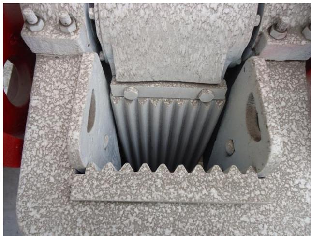
**Figura 11.** Superficies Corrugadas de la Trituradora Primaria.
