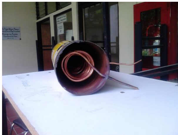
Figura 14. Vista interna del armazón de enfriamiento con el serpentín de enfriamiento incorporado
