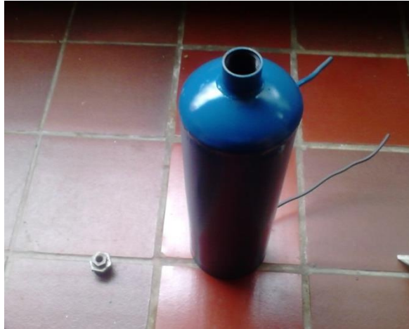
Figura 15. Vista frontal del almac3n de enfriamiento con el serpent3n de enfriamiento incorporado. El almac3n armado tiene una altura de 0.4 m y un radio de 0.14 m, despu3s de este punto se acoplaron estas dos partes a la unidad de refrigeraci3n (Fig. 16), por medio de tuber3a de cobre, dos filtros de refrigeraci3n y un capilar 32 de expansi3n aconsejados por un t3cnico de COLOMBIANA DE FRIO para el funcionamiento adecuado de la unidad posteriormente se cambi3 uno de los filtros por un recolector de condensado.
