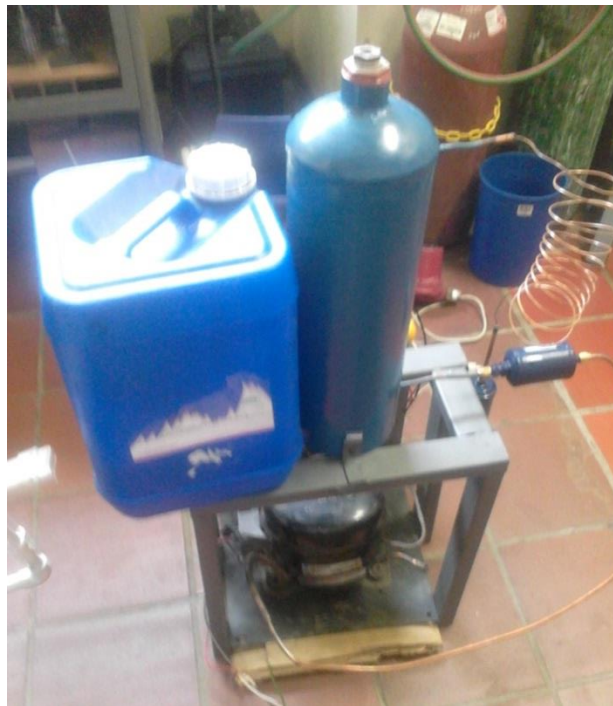
Figura 16. Vista frontal del almac3n de enfriamiento con el serpent3n de enfriamiento incorporados a la unidad de refrigeraci3n con el tanque de suministro
