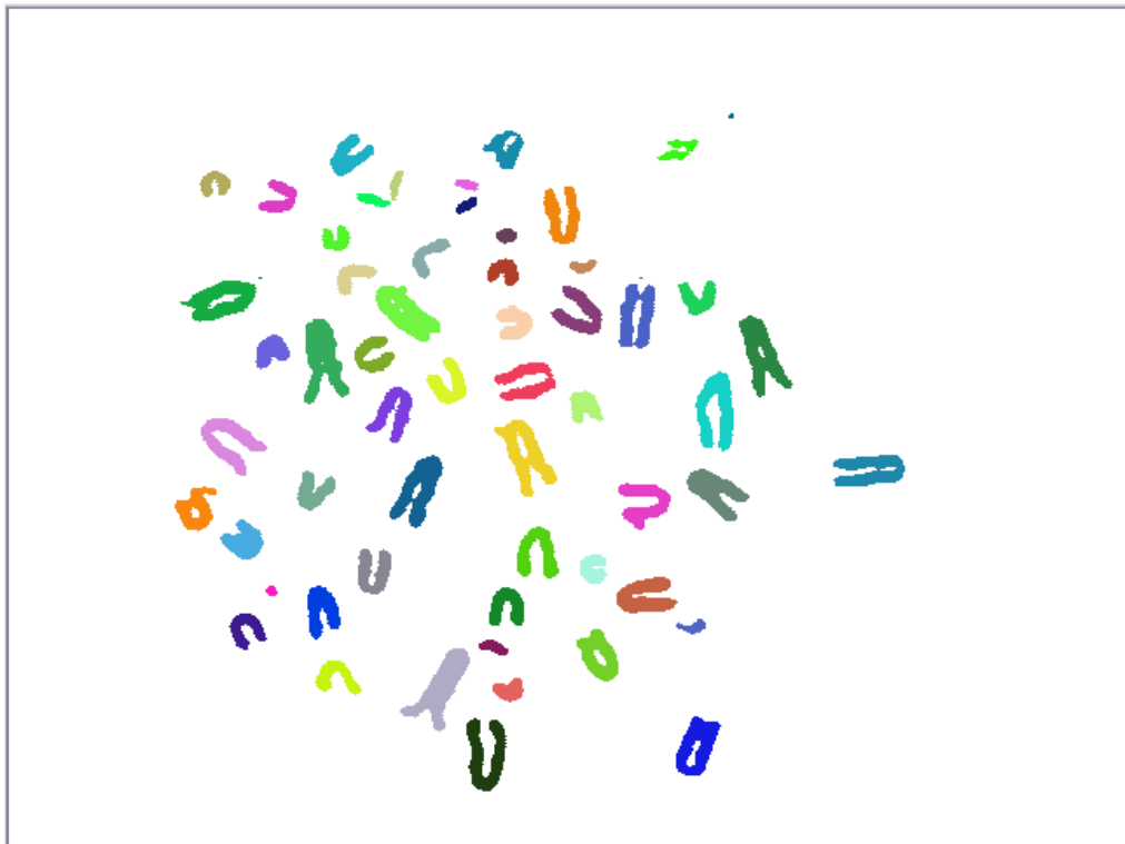
Figura 38. Representación gráfica del resultado del algoritmo de etiquetado. Los colores permiten una clara diferenciación entre los objetos presentes en la imagen
