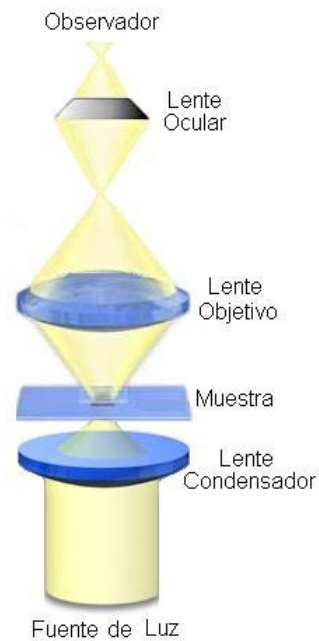
Figura 6. Esquema del microscopio compuesto.
