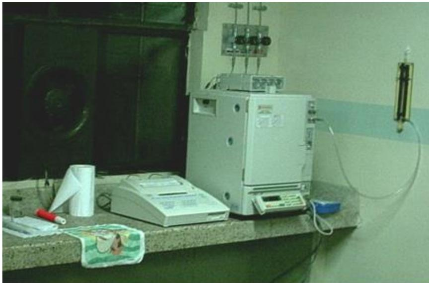
**Figura 3.6.** Cromatógrafo de gases.
