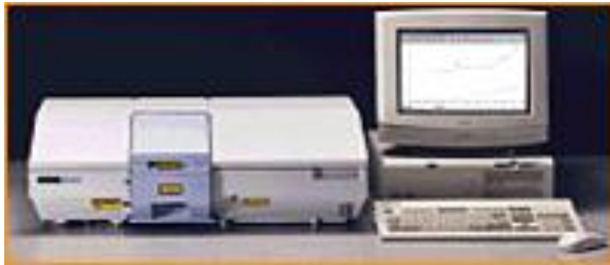
Figura 6. Espectrómetro IR de transformadas de Fourier (FT-IR), Perkin Elemer Spectrum BX2 sistem.
