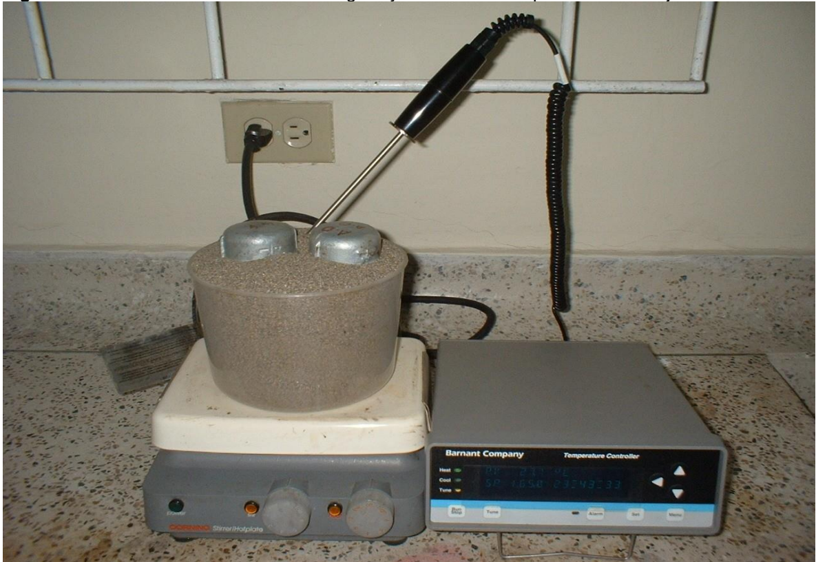
Figura 16. Almacenamiento del asfalto original y modificado con polietileno de baja densidad
