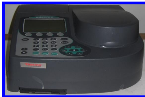
Figura 8. Espectrofotómetro UV-visible, THERMO GENESYS 6
