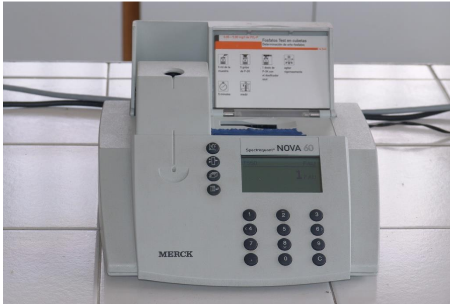
Figura 3. Espectrofotómetro NOVA 60 Espectrofotómetro utilizado para la determinación de Hierro Total y Fosfatos. Cambiando de celda se utiliza para la determinación de Sulfatos
