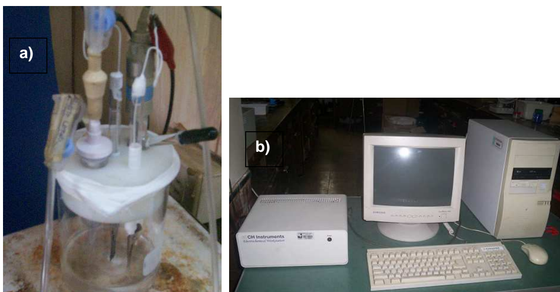
Figura 3.1. a) Montaje de la celda; b) Potenciostato/galvanostato (ECH Instruments)
